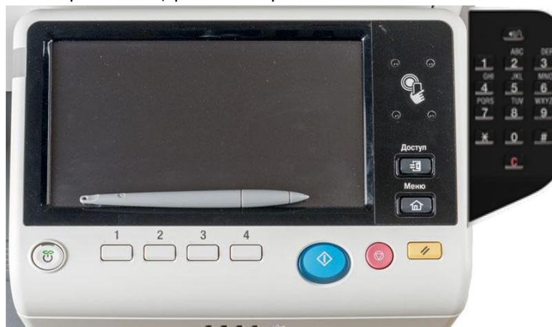
Экран окружен черной рамкой, правая часть которой образует поле, на котором есть зона для установки Bluetooth-подключения с NFC-совместимыми мобильными устройствами, а также две кнопки: возврата на «домашнюю» страницу меню и «Доступ», которая нужна при включенной функции идентификации пользователя.
