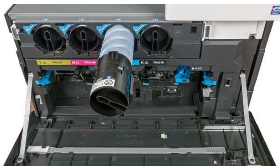
Еще одна дверца, откидная, расположена спереди, выше фронтальных лотков. Она закрывает места установки расходных материалов.
